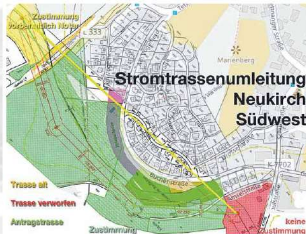
Die Antragstrasse verläuft zwischen der alten Trasse (gelb) und der verworfenen Trasse (rot) und führt nicht durch den Ort.
